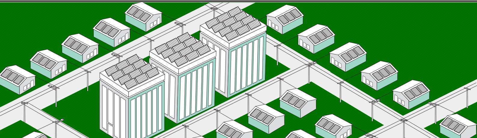
**Pembangkit Listrik Tenaga Surya (PLTS) On Grid merupakan sistem pembangkitan listrik matahari dimana PLTS beroperasi paralel dengan grid (jaringan listrik PLN) yang ditujukan untuk penghematan konsumsi listrik PLN.**
